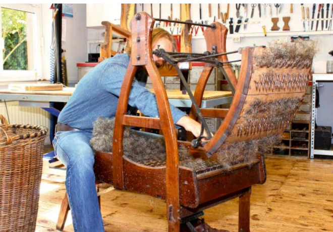
Kein Museumsstück, sondern tägliches Arbeitsgerät: Die Cardeuse aus dem 19. Jahrhundert ist immer im Einsatz
